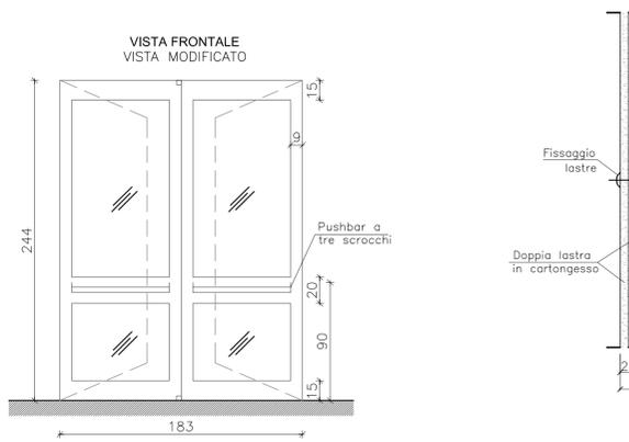
RIMOZIONE DI SERRAMENTO E INSTALLAZIONE DI PORTA USCITA DI SICUREZZA A DOPPIA ANTA CON MANIGLIONE PUSH-BAR. TAGLIO A SPIZZO DEL BANCALE DI MARMO ESTERNO INTERFERENTE COL SENSO DI APERTURA DEL SERRAMENTO (ART.8)
